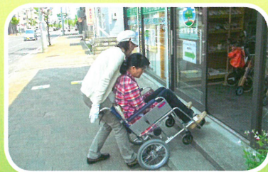
後ろ向きでの移動です。ティッピングレバーを 踏み込み前輪を浮かせた状態です。 前が見えない恐怖感を体験!
